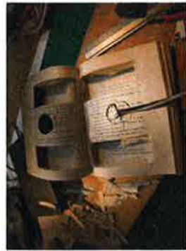
Skær spor til ledning
